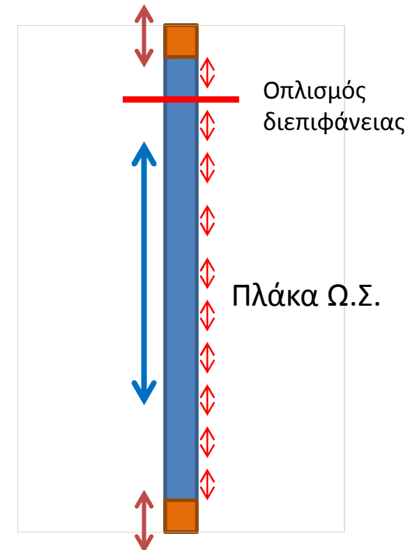
Εμφατινόμενο τοίχωμα και ενδεχόμενη ενίσχυση σύνδεσης με πλάκα Ω.Σ.
